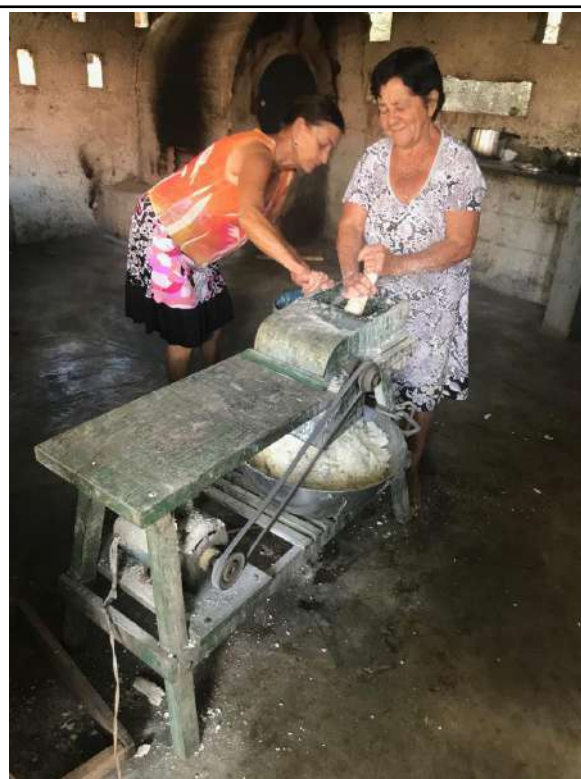
Figura 14: trituração da mandioca e transformação em massa. Fonte: Prefeitura de Araújos.
