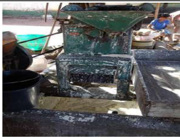
Figura 7: Desintegrador - máquina para ralar a mandioca. Fonte: NUHICRE/IEPHA-2013.
