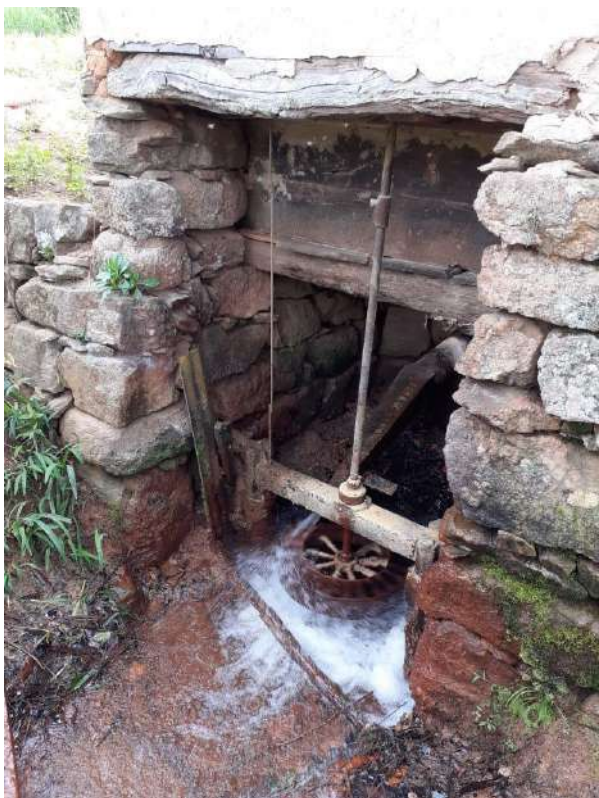
Figura 24: Moinho de pedra movido a água. Município de Santa Rita do Ibitipoca. Fonte: Acervo Iepha-MG.
